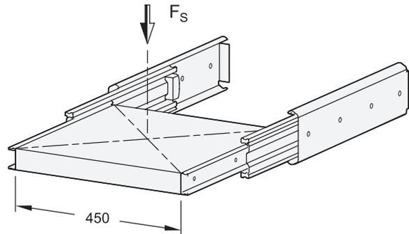
Im Anschluss an jeden Testabschnitt wurden Verschleiß, Laufverhalten und die max. Durchbiegung beurteilt.
