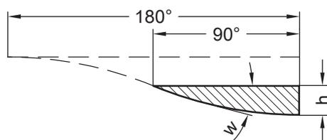
Betrachtet man bei einem Exzenter die durch das Abrollen entstehende Abwicklung stellt man fest, dass diese auf eine sinusförmige Kurve zurück geführt werden kann.
